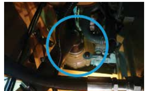
機能テストのために「A30G」に装着したウォーターポンプ。
